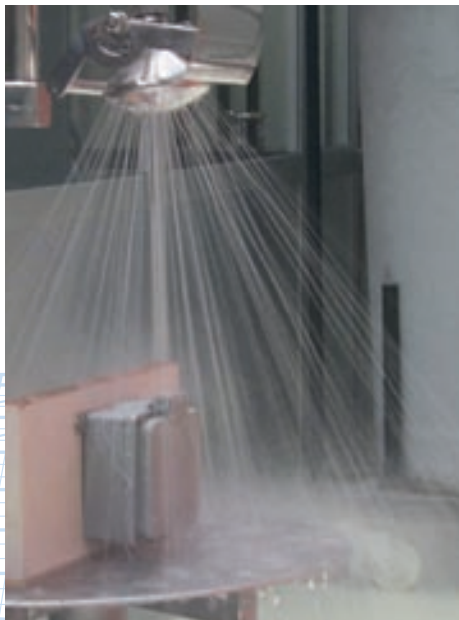
Ensayo grado de protección al agua en caja eléctrica
