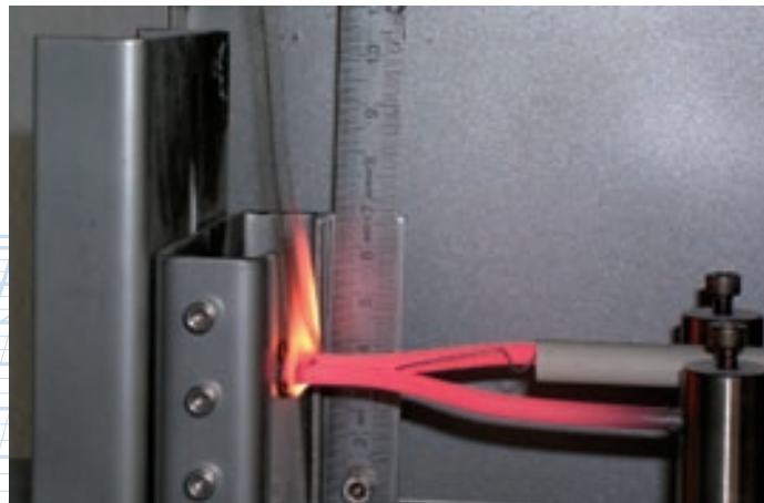
Ensayo de Llama de aguja para envoltente de material eléctrico
