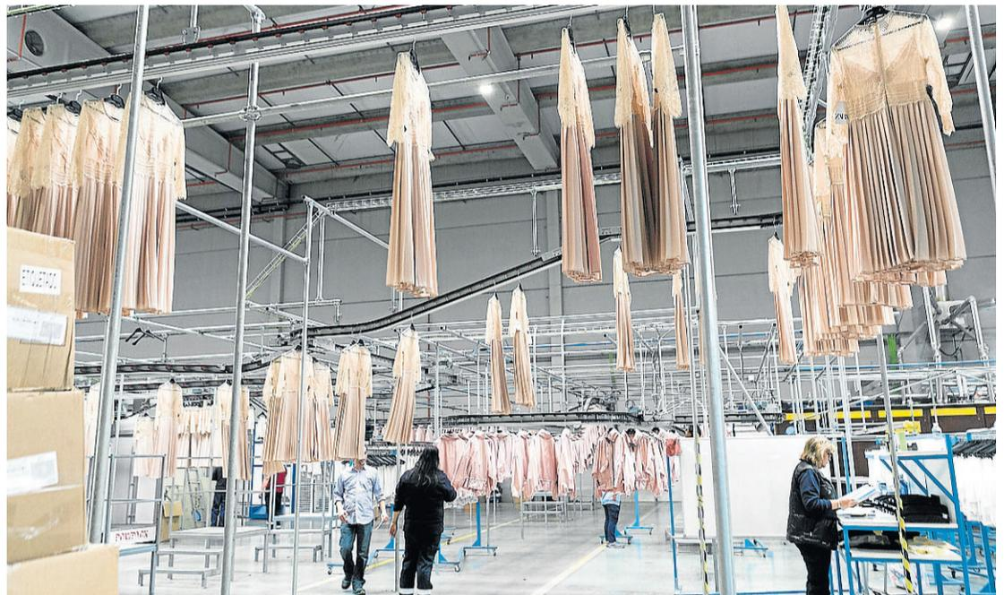
La ropa pasa en perchas por el túnel de planchado de la planta de Lacor Textil, en Plaza. ARÁNZAZU NAVARRO
