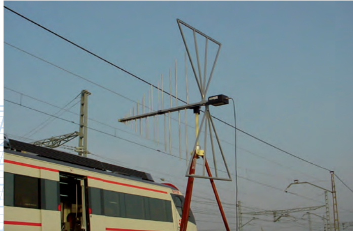
Ensayos de Compatibilidad Electromagnética en ferrocarril
